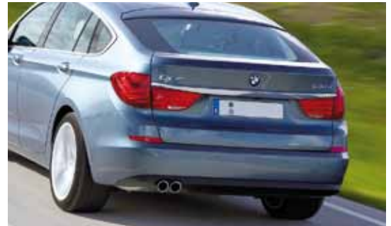
BMW 5er Gran Turismo – die Heckklappe wurde im Gussverfahren hergestellt
