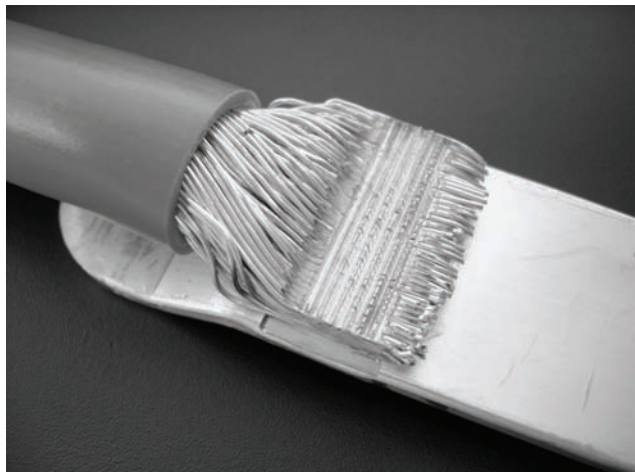
Telsonic Technologie mit Hochleistungs-Ultraschall sorgt erstmals für die sichere Verbindung von Aluminiumleitern.
