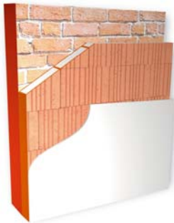
Bild 1: Eine effektive Außendämmung an der Fassade besteht aus einer Schicht Poroton-WDF, als Endbeschichtung reicht herkömmlicher Leichtputz. von links: bestehende Wand, Poroton-WDF, Leichtputz
