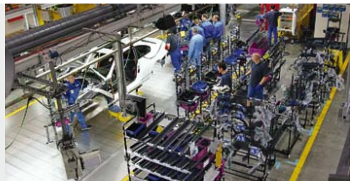
Im BMW Werk Regensburg dient RFID zur Identifikation der Fahrzeuge auf dem Produktionsband mit Vernetzung zu den Arbeitsschritten
