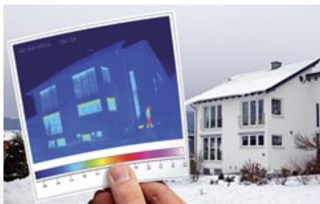
Überprüfung der Qualität von Neubauten mit Hilfe von Wärmebildern (Bild: Fotolia, Ingo Bartussek)
