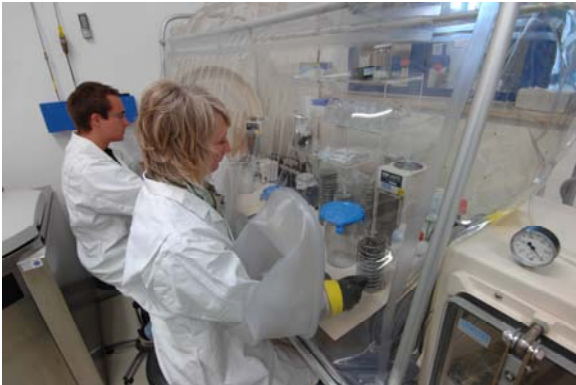
Anzucht von "Methanos" unter Ausschluss von Luftsauerstoff in der Anaerobenkammer
