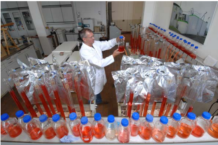
Ermittlung der Gasmehrerträge durch Zusatz von „Methanos“ im Gärversuch.
