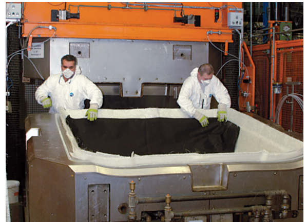
Herstellung von Composite-Bauteilen im Reaktivverfahren bei Fritzmeier Composite GmbH & Co. KG
