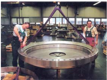
momentenlager.jpg: Das Nautiluslager in der Endmontage.
