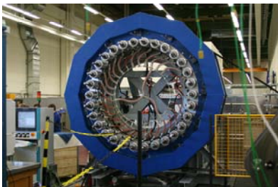
Dieses Foto (IMG_0002) zeigt den Teststand für das Nautiluslager.
