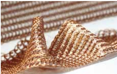
Kupfergestrick für elektrische Flächenheizungen, von CoTexx, z. B. für Flugzeugtragflächen
