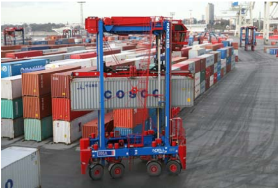
Noell Straddle Carrier mit Hybridantrieb im Hafeneinsatz
